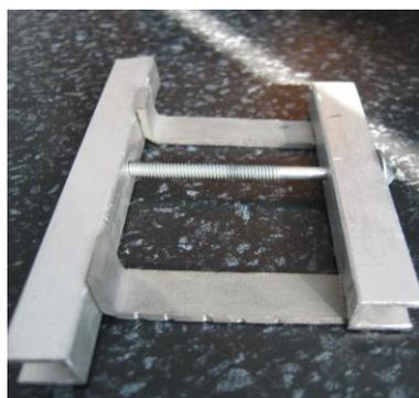
Рисунок 3а – Образцы, зафиксированные винтовым зажимом в удерживающей рамке. На торце образца пропилены после резания
