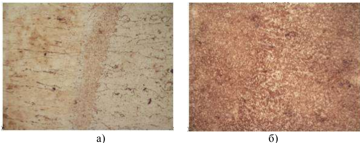
Рис. 21. Мікроструктура зразків з наплавленим металом: а – наплавлений шар; б – зона сплавлення ( \times 100 )
