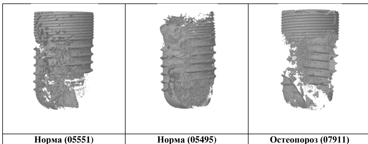
Рисунок 22 – Образцы из сплава ВТ6 с модифицированным покрытием
