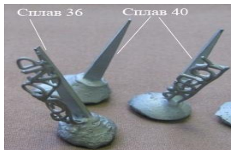
Рис. 1. Демонстративні проби для оцінювання рідкоплинності розроблених сплавів 40 та 36.
