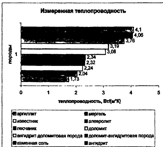
Рис 1. Теплопроводность минералов, измеренная методом бесконтактного сканирования в лаборатории проблем геотермии МГГРУ.
