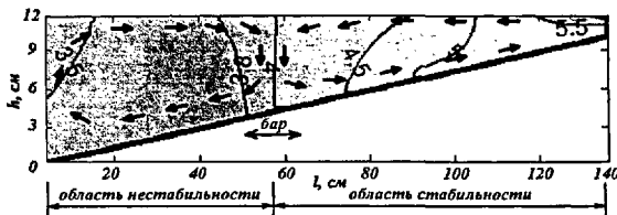
Рис. 6. Распределение температуры и схема течений в лабораторной модели.
