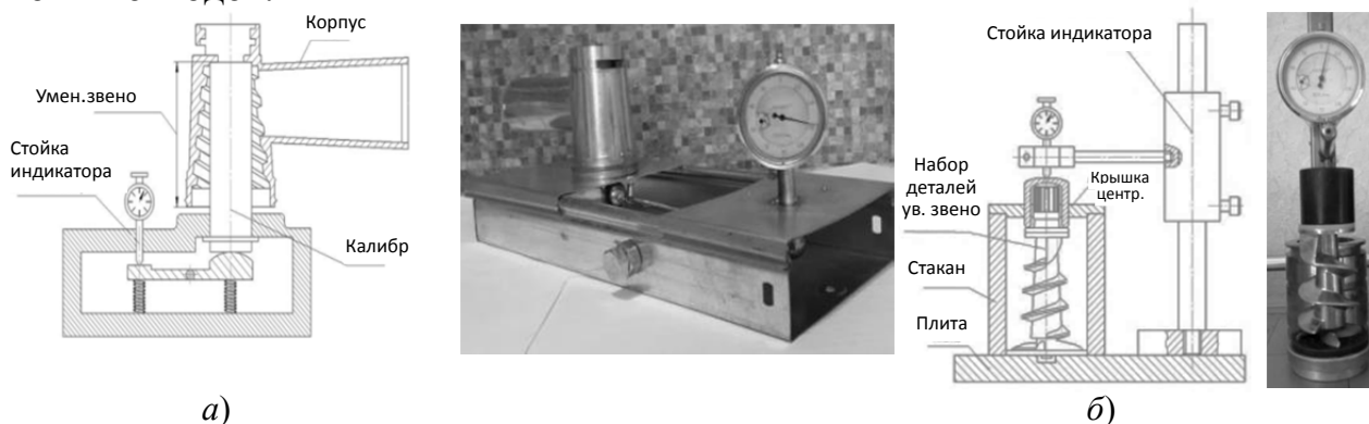
Рисунок 14 – Схемы и стенды для измерения размеров уменьшающей (а) и увеличивающей (б) ветвей размерной цепи
