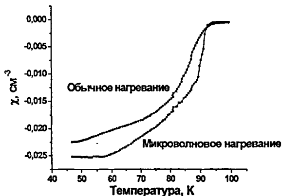
Рис. 7. Температурная зависимость магнитной восприимчивости образцов Bi 2 Sr 2 CaCu 2 O x , синтезированных микроволновым и термическим разложением смеси нитратов.
