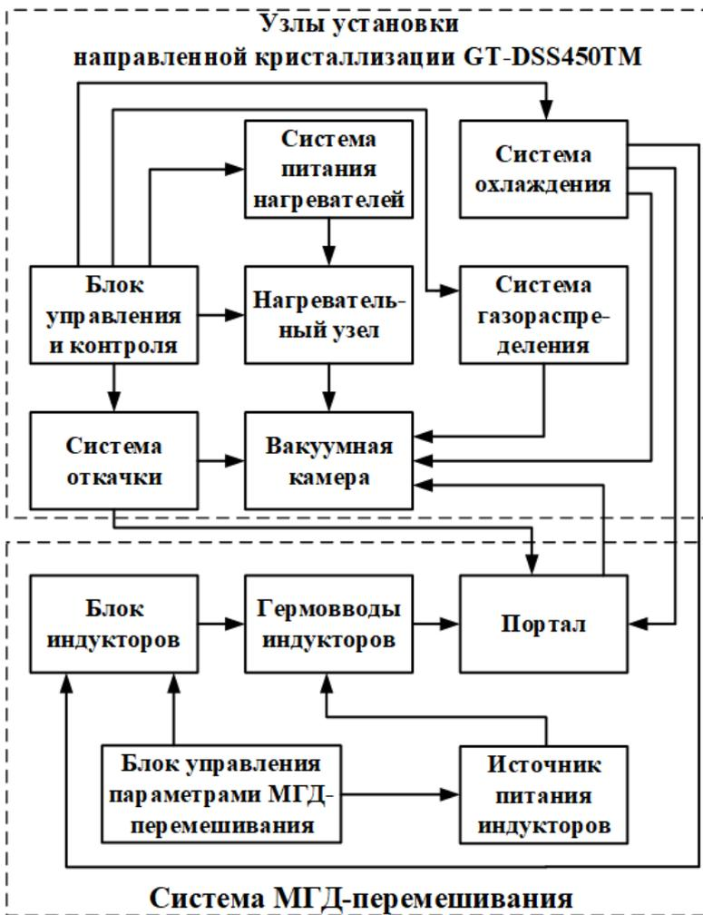
Рисунок 3.1 – Структура экспериментальной установки для исследования процесса МГД-перемешивания расплава кремния
