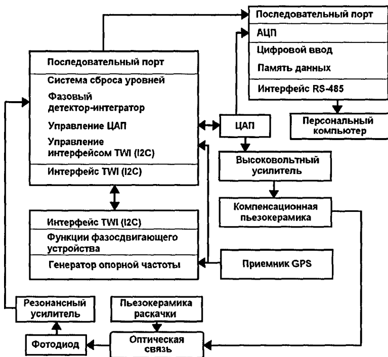
Рисунок 10 - Система цифровой регистрации лазерного деформографа, установленного в горной выработке СКРУ-2, Соликамск
