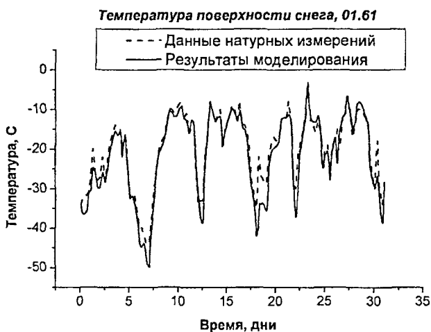
Рис 2.6 Температура поверхности снега в Колпашево по результатам расчетов и данным измерений Декабрь, 1961 г
