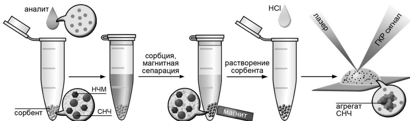
Рисунок 8. Схема проведения анализа, основанного на совмещении твердофазной экстракции и ГКР (ТФЭ-ГКР).
