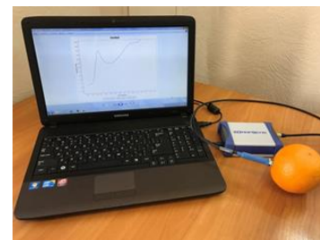
Рисунок 3.3. – In situ определение аскорбиновой и щавелевой кислот методом вольтамперометрии в апельсине
