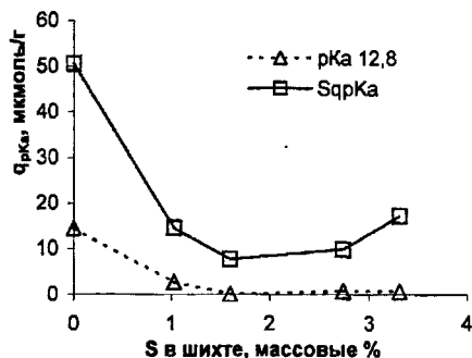
Рис. 3. Влияние серы на содержание центров с pK_a 12,8 и \Sigma q_{pKa} на поверхности электролюминофоров \text{ZnS:Cu,Al}
