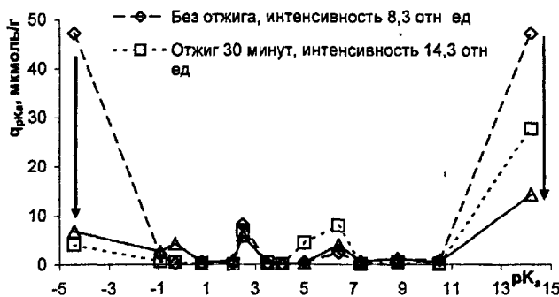
Рис. 4. Влияние отжига на распределение центров адсорбции ZnS:Cu,Al ЭЛФ
