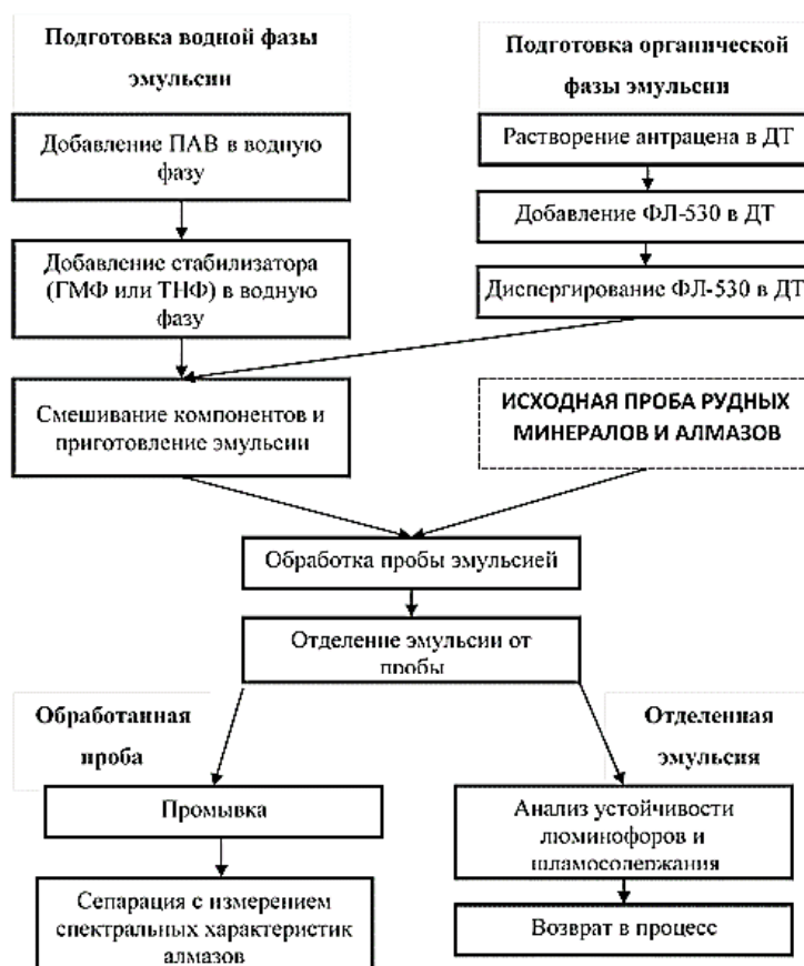
Рисунок 6 - Принципиальная схема проведения эксперимента при укрупненных лабораторных исследованиях
