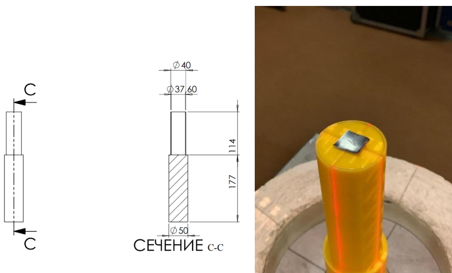
Рис. 3. Схема конструкции из пластика.
