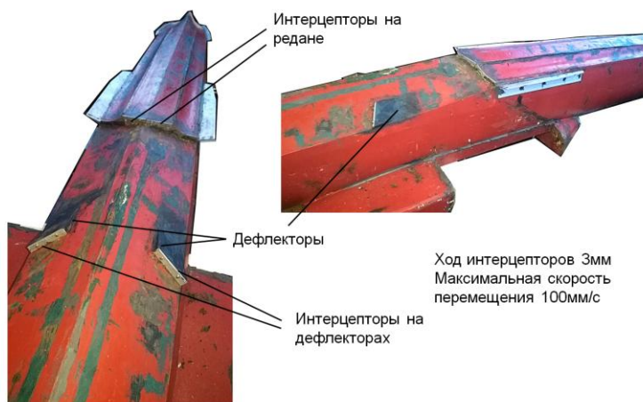
Рисунок 2 – Изображение модели самолета-амфибии, оснащенной неподвижными интерцепторами на редане и дефлекторах
