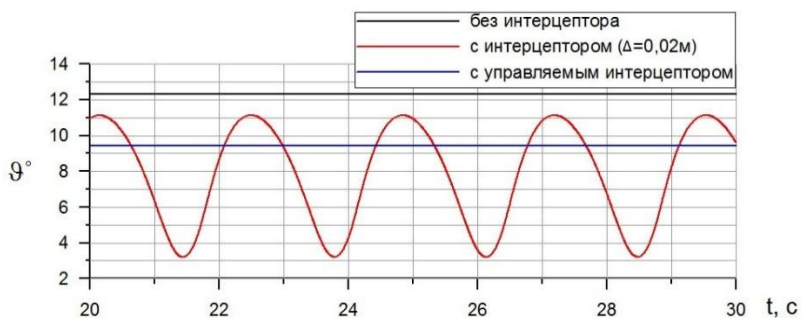
Рисунок 10 – Временная зависимость угла дифферента при движении по спокойной воде со скоростью V=30\text{ м/с}
