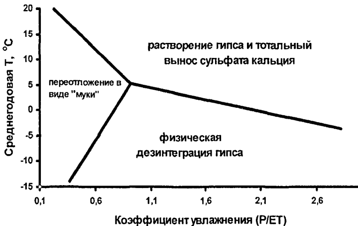
Рис. 7. Макрогеографические закономерности проявления дезинтеграции и других педогенных процессов на плотных гипсах – их зависимость от среднегодовой температуры и коэффициента увлажнения.
