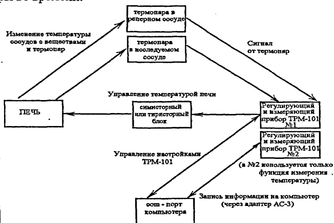
Рис. 1. Блок-схема разработанной нами установки для проведения ДТА
