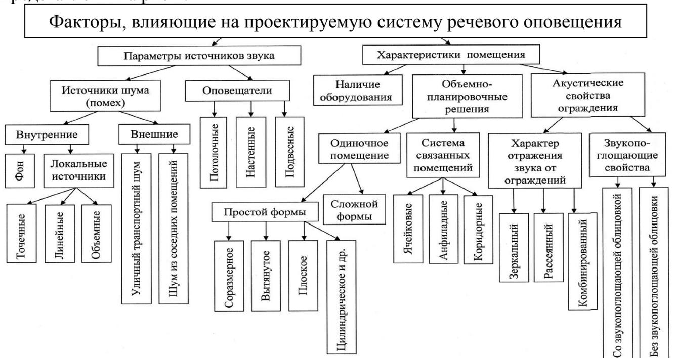
Рисунок 2. Факторы, влияющие на проектируемую систему речевого оповещения
