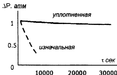
Рис.8. Кинетика уменьшения давления газа ( \text{N}_2 ) при его истечении через асимметричные мембраны, s=0.07\text{см}^2 (эффект уплотнения колончатой микроструктуры при рекристаллизации с флюсом)
