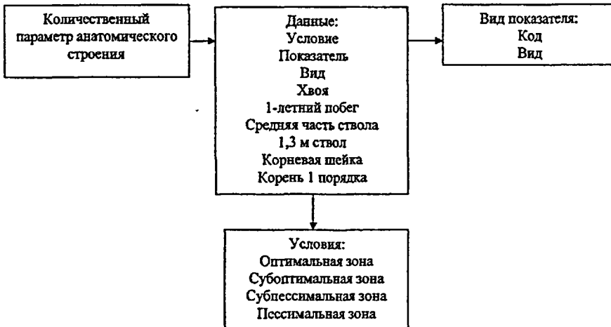
Рис.4. Структура базы данных компьютерной программы для определения комфортности среды на основе анатомических параметров сосны
