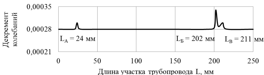
Рисунок 8 – Зависимость декремента колебаний на «рабочей» форме от длины участка трубопровода L
