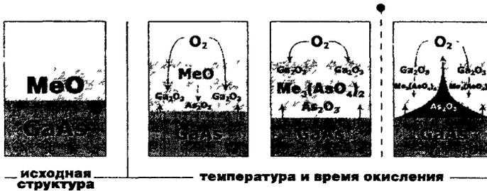
Рис. 9. Схема процессов, протекающих при окислении структур MeO/GaAs
