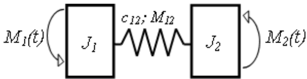
Рисунок 3 – Еквівалентна динамічна схема однокінцевої піднімальної установки: J_1 – сумарний зведений до осі органа навівання момент інерції ротора двигуна, редуктора і барабана з урахуванням маси каната, \text{т} \cdot \text{м}^2 ; J_2 – зведений до осі барабана момент інерції кінцевого вантажу з урахуванням маси каната, \text{т} \cdot \text{м}^2 ; c_{12} – зведена жорсткість каната, \text{кН} \cdot \text{м/рад} ; M_1 – зведений зовнішній момент кінцевого вантажу, \text{кН} \cdot \text{м} ; M_2 – зведений зовнішній момент, що прикладається до барабана, \text{кН} \cdot \text{м} ; M_{12} – момент сили пружності каната, \text{кН} \cdot \text{м}
