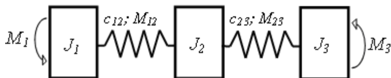
Рисунок 5 – Еквівалентна крутильна динамічна схема однокінцевої піднімальної установки: J_1 – сумарний зведений момент інерції ротора двигуна, редуктора і барабана, \text{т} \cdot \text{м}^2 ; J_2 – зведений момент інерції напрямного шківів; J_3 – зведений момент інерції кінцевого вантажу; c_{12} – зведена крутильна жорсткість струни каната, \text{кН} \cdot \text{м/рад} ; c_{23} – зведена крутильна жорсткість прямовису каната; M_{12}, M_{23} – моменти сил пружності в ланках, \text{кН} \cdot \text{м} ; M_1, M_3 – зведені зовнішні моменти, що прикладаються відповідно до барабана і кінцевого вантажу, \text{кН} \cdot \text{м}
