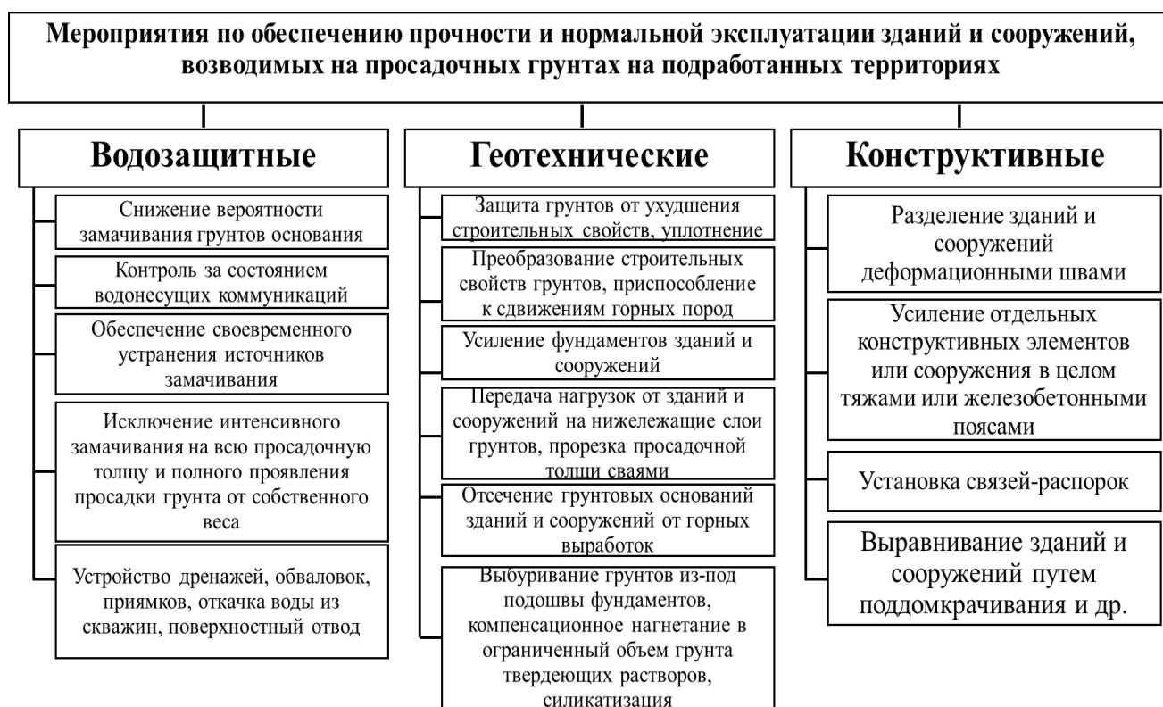
Рисунок 7 – Мероприятия по обеспечению нормальной эксплуатации зданий и сооружений, возводимых на просадочных грунтах в условиях подработки
