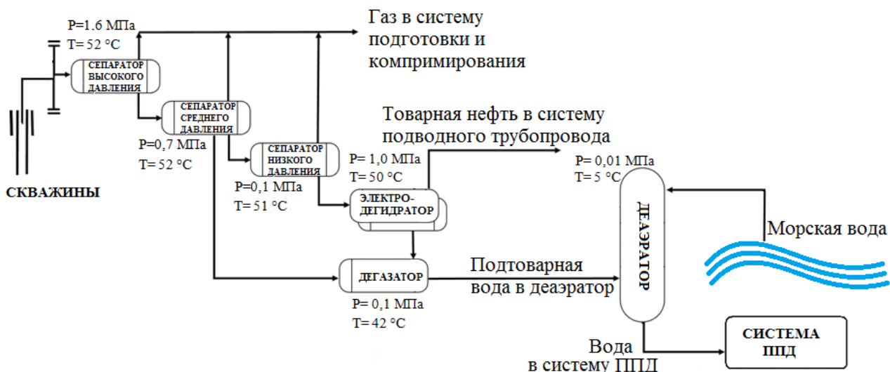
Рисунок 1 – Технологическая схема подготовки нефти на платформе ПА-А
