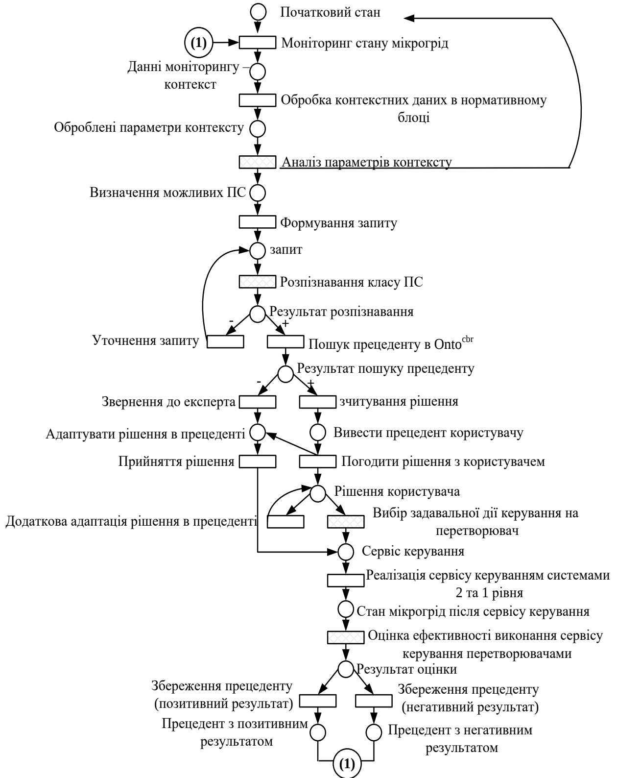
Рис.5 – Модель потоків даних в контекстно-залежній системі керування перетворювачами
