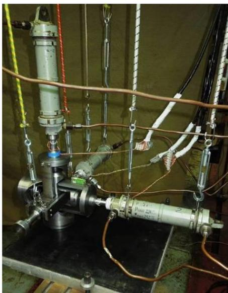
Рисунок 3. Установка для испытания на трёхосное растяжение
