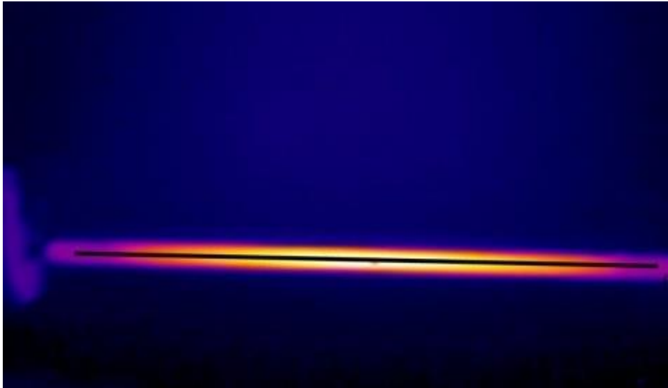
Рисунок 8 – Температурное поле ФСНМ с люминофорным покрытием
