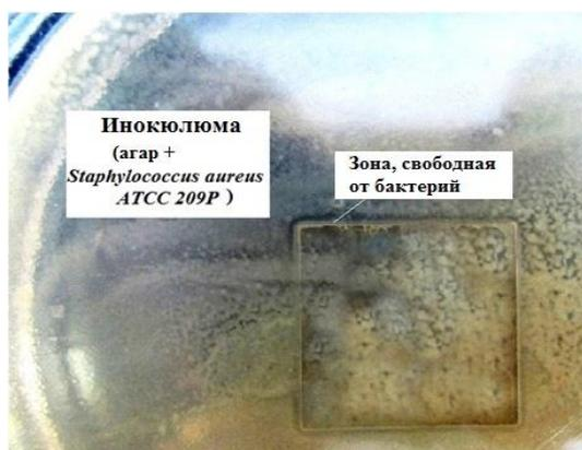
Рис.7 Фотография, иллюстрирующая высокую прозрачность и бактерицидные свойства смешанного  $ZnO-CeO_2$  покрытия, нанесенного на поверхность стекла полимерно-солевым методом с использованием ПВП. Темная линия, обрамляющая образец, отражает границу зоны, в которой бактерицидным покрытием подавляется развитие бактерий
