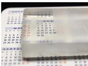
Рис.11 Фотография заготовки оптического стекла К8 после шлифовки, на левую часть поверхности которой нанесено композиционное  $Zn(NO_3)_2$ /ПВП иммерсионное просветляющее покрытие
