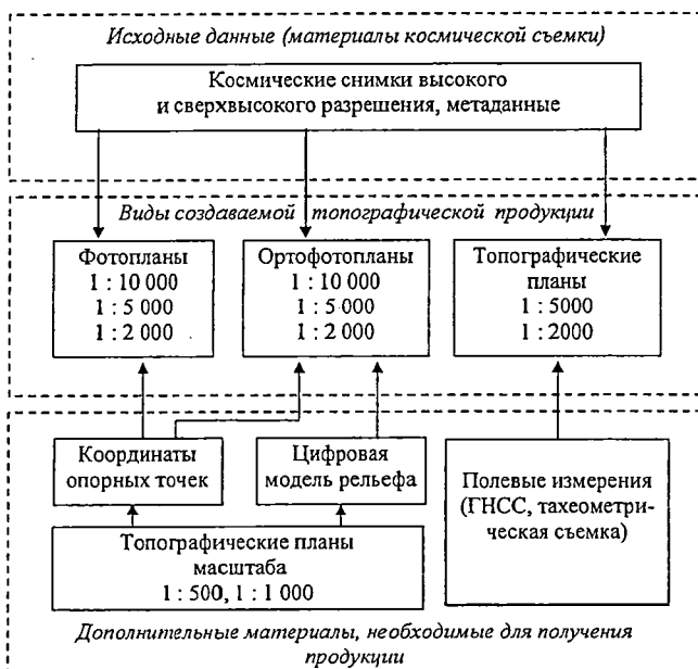
Рисунок 2 – Технологическая схема создания цифровой топографической продукции по космическим снимкам высокого и сверхвысокого разрешения
