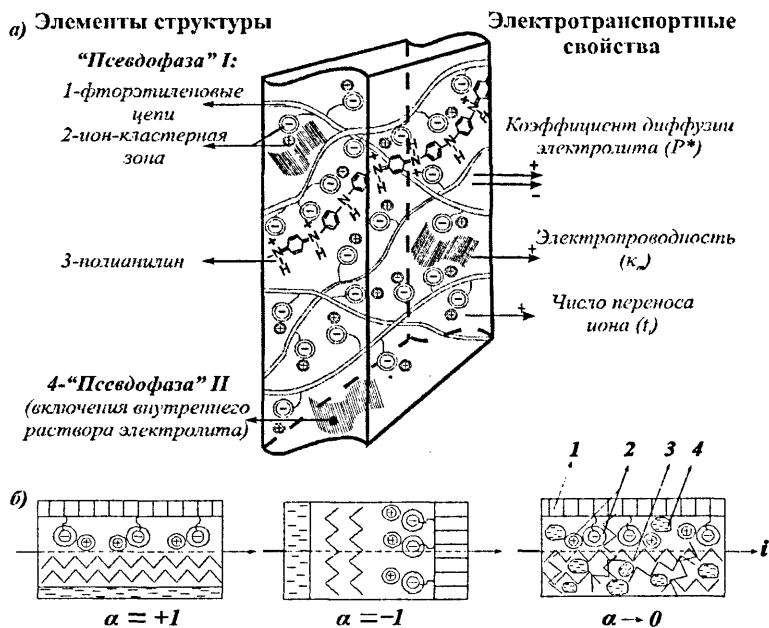
Рисунок 10 – Схематическое представление композитной мембраны и электротранспортных свойства мембранной системы (а), а также модели пространственной ориентации «псевдофаз» по отношению к направлению тока (б)
