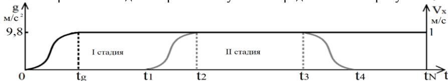
Рисунок 6 – Схема нагружения геологической модели внешними воздействиями во времени: ускорения свободного падения g и горизонтальной скорости V_x
