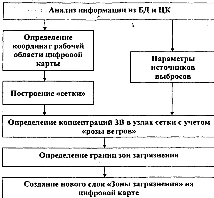
Рис. 3. Схема процедуры построения геоимитационной модели зон загрязнения
