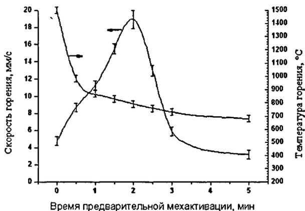
Рис.7. Зависимость скорости и температуры горения смеси состава (Ti-2,1В)-60масс.% Си от времени механической активации для образцов насыпной плотности.
