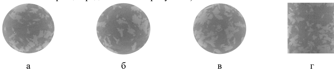
Рисунок 2 – Микрофотографии образца керна (интервал отбора 1444,0-1449,0 м): поперечное сечение верхней трети образца (а), поперечное сечение середины образца (б), поперечное сечение нижней трети образца (в), продольное сечение вдоль оси Х (г)
