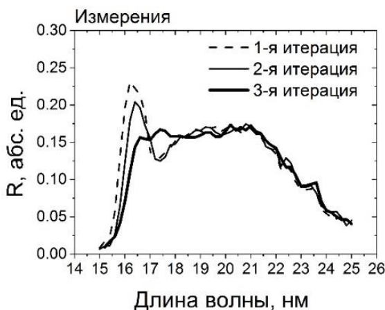
Рис. 4. Результаты корректировки технологического процесса для получения плато коэффициента отражения в диапазоне 17-21 нм
