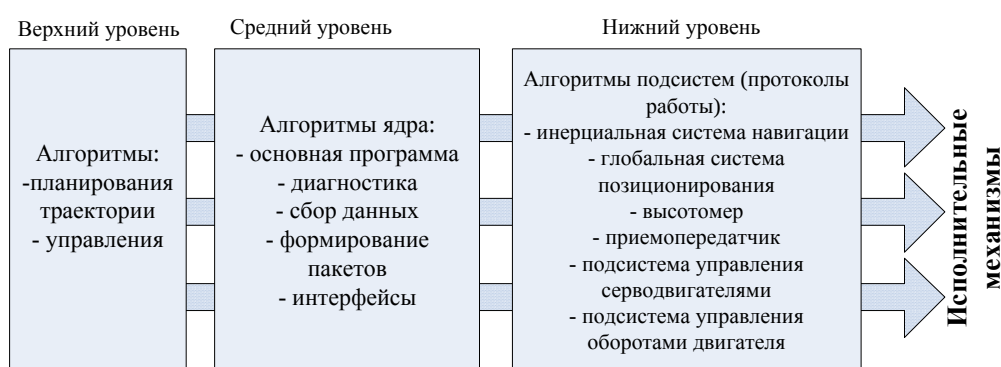
Рисунок 8 – Пример реализации программно-аппаратного комплекса для проектирования и исследования автопилотов летательных аппаратов вертолетного типа
