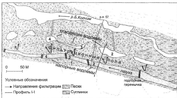
Рис. 2. Схема системы очистки воды в фильтрационных полях
