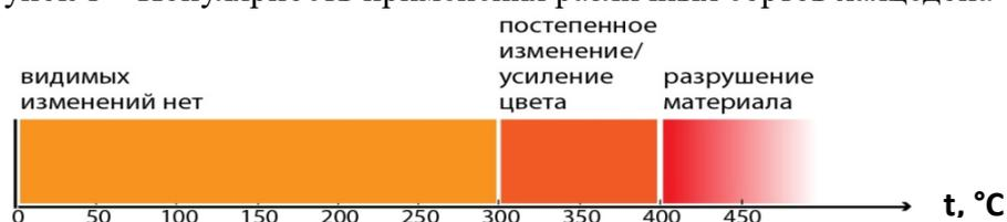
Рисунок 2 – Динамика изменения цвета халцедона, окрашенного методом термообработки
