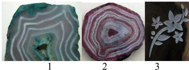
Рисунок 5 – Образцы халцедона с нанесенным рисунком: 1 – травление фтористоводородной кислотой; 2 – локальная пропитка синтетическим красителем «Бордо»; 3 – окрашивание халцедона термообработкой с последующим нанесением рисунка при помощи лазерной обработки
