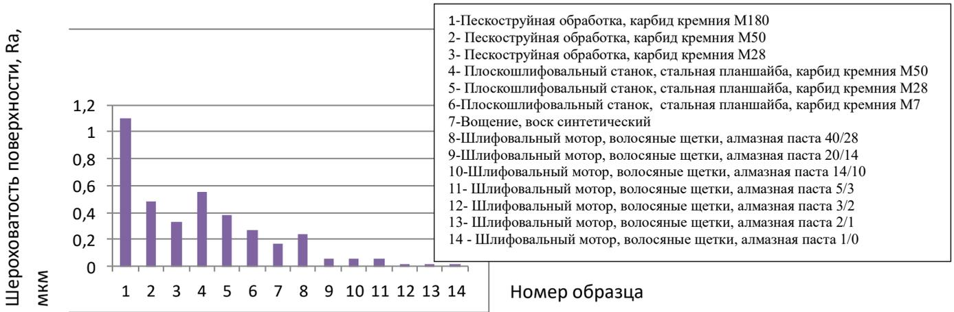
Рисунок 7 – Зависимость качества поверхности от вида ее обработки
