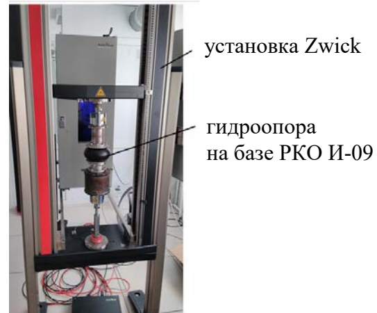
Рис. 17. Экспериментальный стенд для изменения жёсткости гидроопоры
