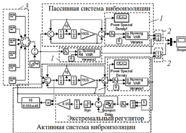
Рис. 13. Модель в программе Simulink: 1 – блок определения дисперсии; 2 – блок вычисления K_n ; 3 – блок формирования полигармонического сигнала
