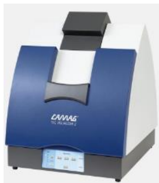
Рис. 5. А. Визуализатор для регистрации флуоресценции образцов в 96-луночных планшетах. Б. Пример получаемой фотографии планшета (группы по 6 лунок принадлежат разным образцам (выделены белыми линиями)).
