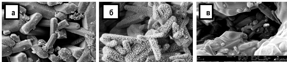
Рисунок 13 – СЭМ изображения поверхности: а) ГА(90)-СЛГ, б) ГА(75)-СЛГ, в) ГА(50)-СЛГ
