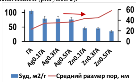
Рисунок 4 – Площадь удельной поверхности и средний размер пор Zn_xGA и Ag_xGA
