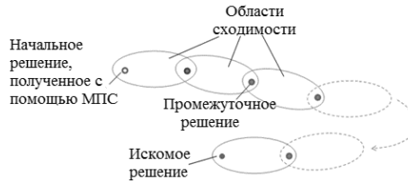
Рисунок 3 – Схема процедуры расчета перемещений узлов в МКЭ
