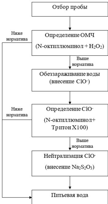
Рис. 10. Схема определения качества питьевой воды во внелабораторных условиях
