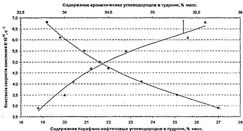
Рис. 4. Зависимость изменения константы скорости окисления гудрона от содержания в нем парафино-нафтеновых и ароматических углеводородов
