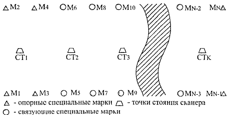
Рисунок 6 – Схема прокладки сканерного хода
