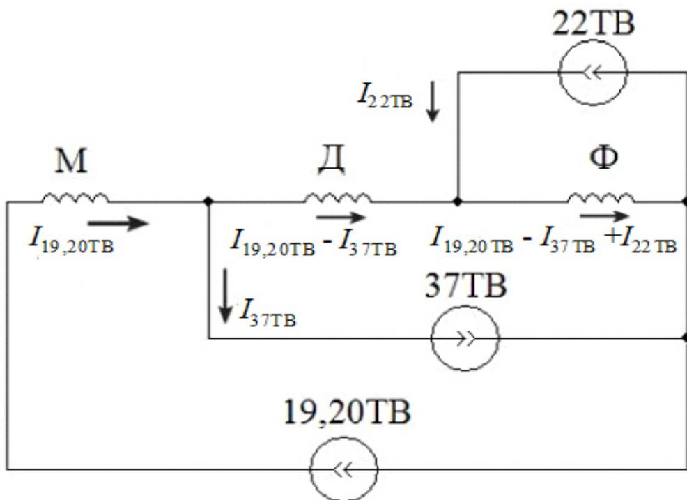
Рисунок 1 – Эквивалентная схема последовательного питания магнитов Нуклотрона. М - дипольные (поворотные) магниты Нуклотрона. Д – дефокусирующие магниты; Ф – фокусирующие магниты;  $I_{19,20ТВ}$  – ток главного источника питания Нуклотрона 19,20ТВ (до 6 кА);  $I_{37ТВ}$ , – ток источника токоотбора 37ТВ (до 600 А) и  $I_{22ТВ}$  – ток источника токодобавки 22ТВ (до 200 А)
