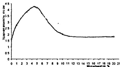
Рис. 5 Ударная вязкость образцов серного цемента
